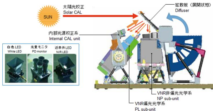
図 2-13 VNR 太陽光・内部光源校正機能
