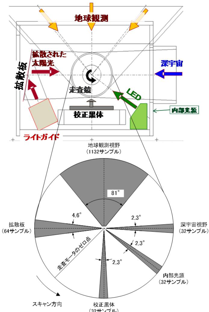
図 2-12 IRS 走査角度と視野の定義
