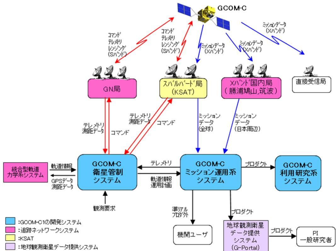
図 3-1 GCOM-C 地上システム概要
