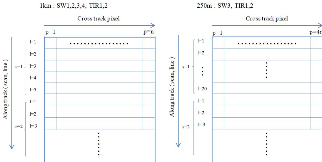
図 4-15 IRS ラインとピクセルの関係
